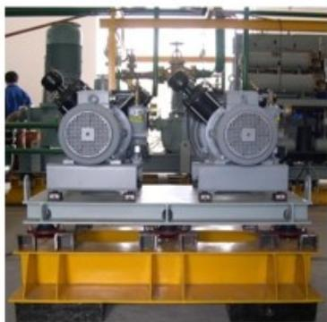
扫雷艇空压机组浮筏隔振系统设计
